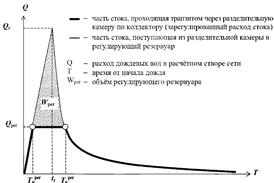
Рисунок Е.1 Гидрограф дождевого стока в сети дождевой канализации с разделительной камерой (ливнесбросом) и регулирующим резервуаром
